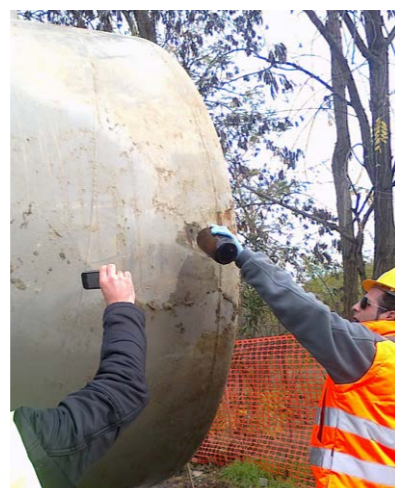
Controlli d'integrità Serbatoi con Spessimetro, Thickness Test e Adhesion Test
