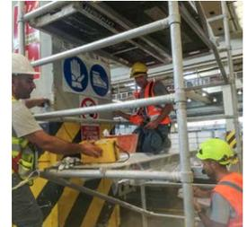
PRINCIPALI PROVE EFFETTUATE: Indagini simiche passive. Misurazione del rumore ambientale (microtremori) al suolo e sulle strutture. Indagini sismiche di superficie MASW. Sondaggi geognostici a carotaggio continuo Prove penetrometriche dinamiche DPSH. Caratterizzazione meccanica dei materiali. Indagine ultrasonora. Prelievi campioni di cls e di acciaio
