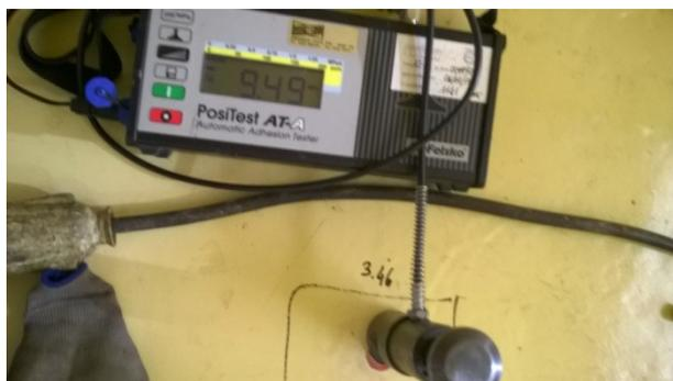
perpendicolarmente alla superficie del rivestimento con un adesivo. Dopo l'essiccazione dell'adesivo, sul piolo si posiziona un apparecchio che serve per applicare una tensione perpendicolare alla superficie di prova. La forza applicata viene aumentata gradualmente e
