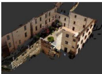
Dopo la fase preliminare di due diligence per il reperimento della documentazione storica si procede con il rilievo geometrico-strutturale. In generale il rilievo è effettuato con tecnologia laser scanner 3D e restituzione di nuvola di punti e generazione di modello BIM
